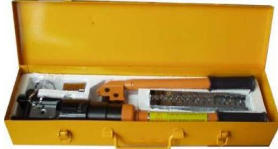
**ВНИМАНИЕ!** Пресс гидравлический ручной электромонтажный ПРГ-240 не предназначен для обжима наконечников и гильз, выполненных из нержавеющей стали!
